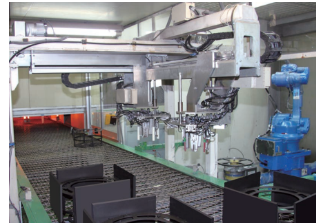
全自動ロボット塗装・乾燥ライン
